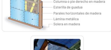
**2.4 BAHAREQUE ENCEMENTADO:** La estructura es similar a la de todos los bahareques y la diferencia está en el revestimiento. En esta técnica la estructura de madera se cubre con esterilla y a esta se le clava una malla metálica que sirve de soporte para recibir el revoque de cemento que puede ser estucado (enyesado), lo cual le da una textura lisa que se pinta con pinturas a base de agua.
